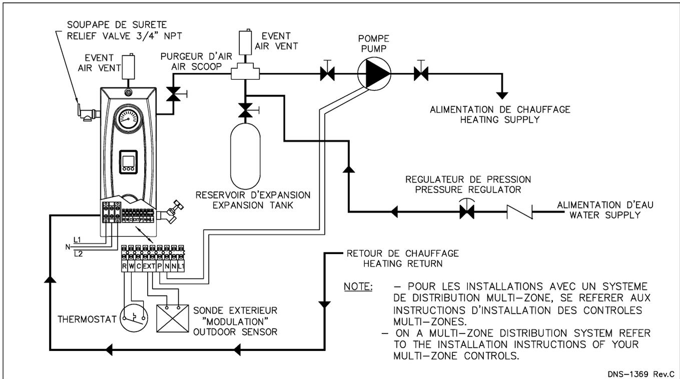
**Figure 7: Diagramme multizone avec plus d'un circulateur**
