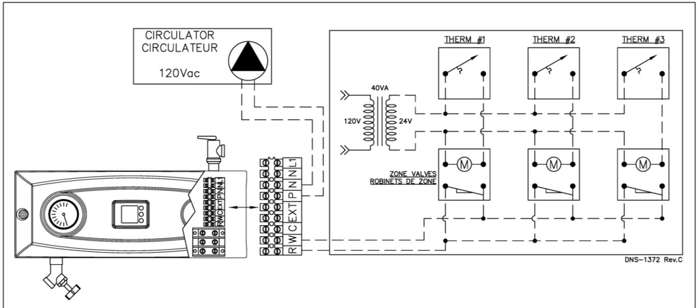
Figure 9: Diagramme électrique
